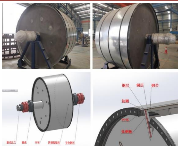
图29.阴极辊及其内部组件示意
