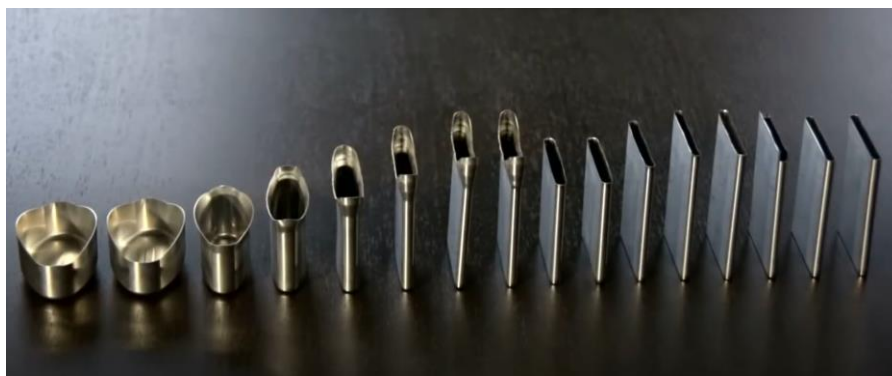
图 15：冲压拉伸工艺
