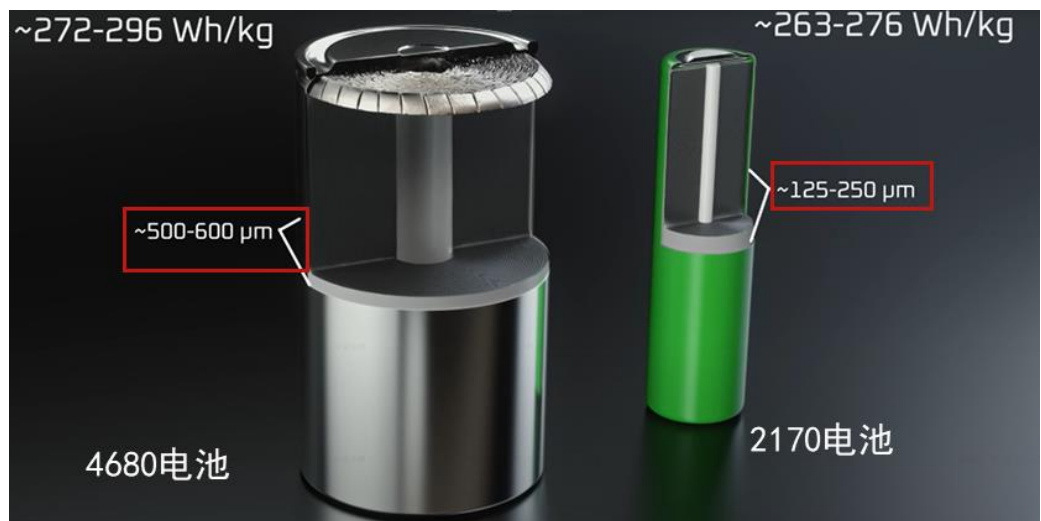
图 24：2170 电池与 4680 电池壁厚对比
