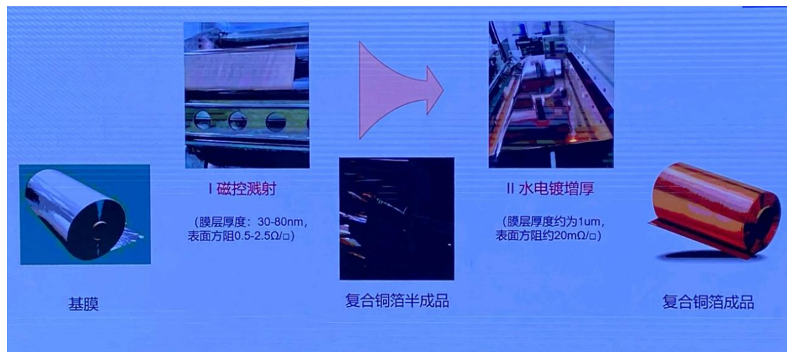
图表：锂电复合铜箔两步法制程
