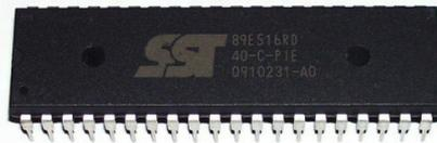
**仿真芯片的作用：**仿真芯片可以实现计算机与实验板之间的真正在线调试，用KEIL软件连接好仿真器后可以在软件调试模式下进行单步的执行指令、可设置断点、等。每执行一条指令都可看见实验板的运行状态，并且可随时查看各个变量的值，对初学者非常有帮助。如果不使用仿真芯片而直接使用板上单片机调试程序只能全速执行指令，通过实验板现象来重新修改程序，再次下载。
