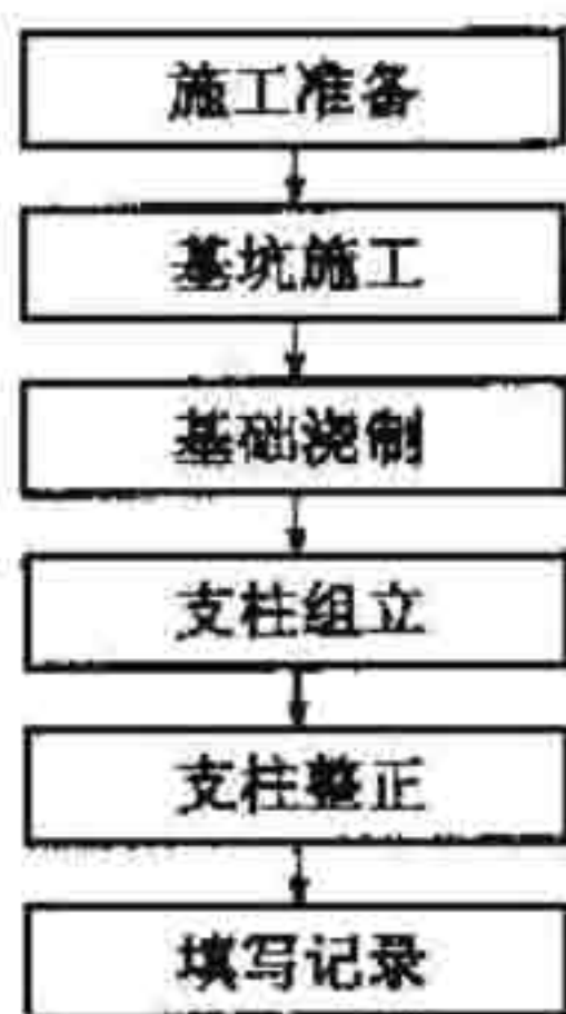
图 3.0.1 接触网支柱施工 工序流程
