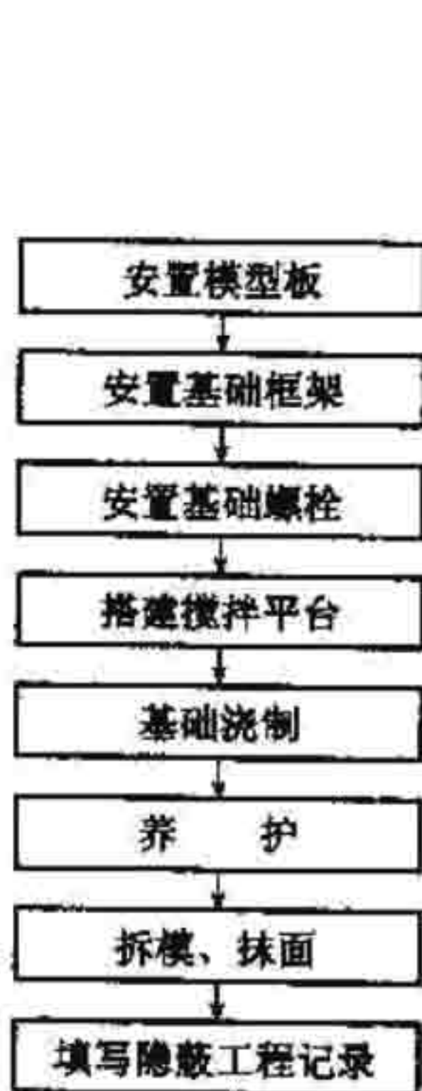
图 5.2.1—1 法兰盘 基础浇制施工 工序流程
