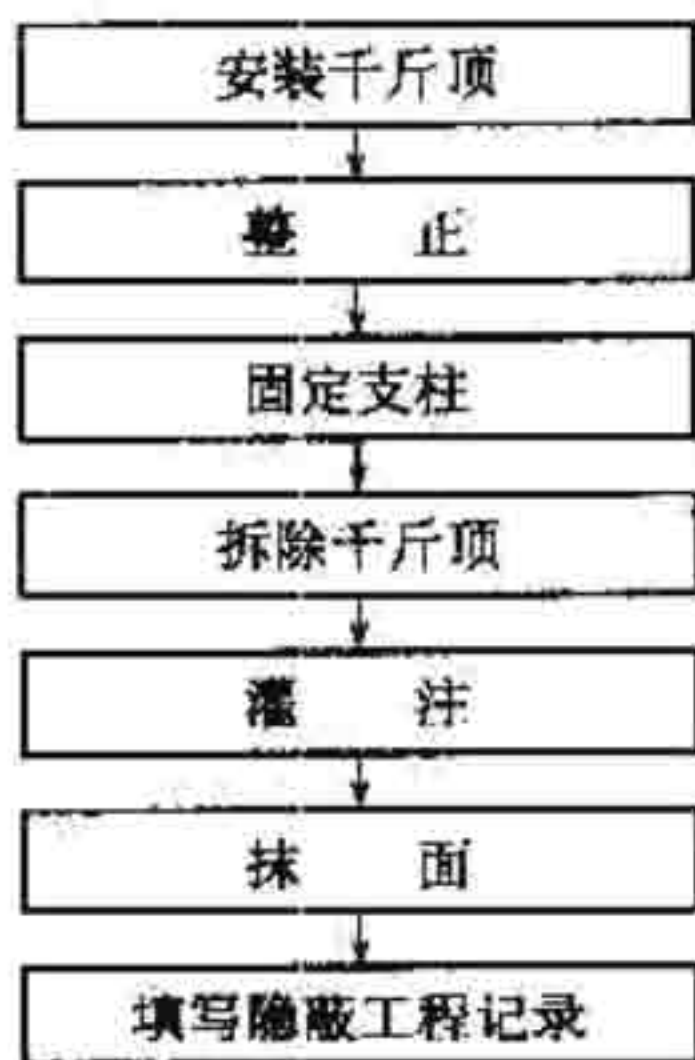
图 7.4.1 杯型基础支柱整正施工工序流程
