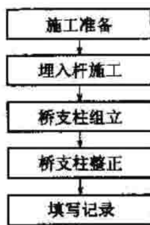
图 3.0.2 桥上接触网支柱 施工工序流程
