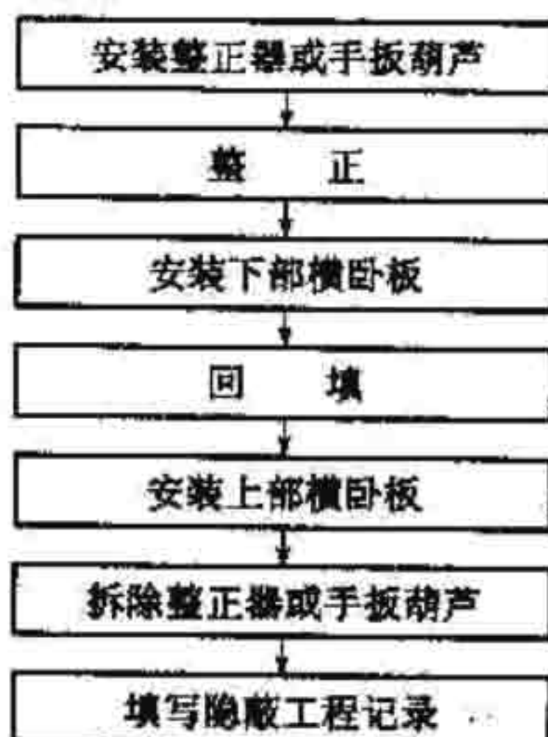
图 7.2.1 直埋式支柱整正施工工序流程
