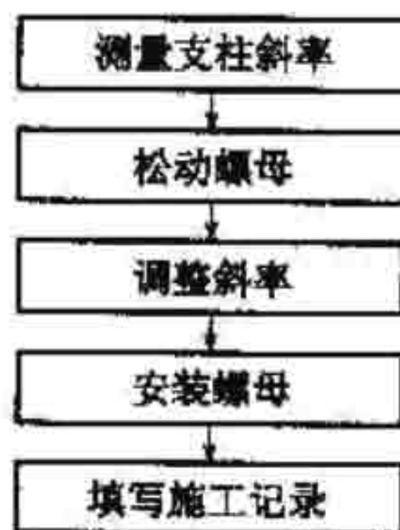
图 7.3.1 法兰盘式支柱整正施工工序流程
