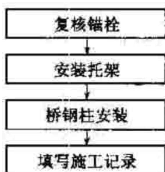
图 6.5.1 桥钢柱组立施工工序流程
