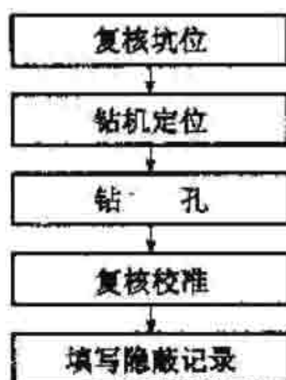
图 4.2.1 机械钻孔施工工序流程
