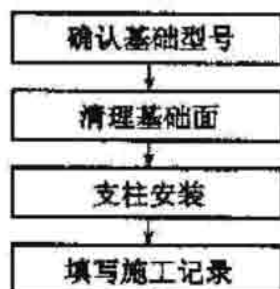
图 6.3.1 法兰式支柱组立施工工序流程
