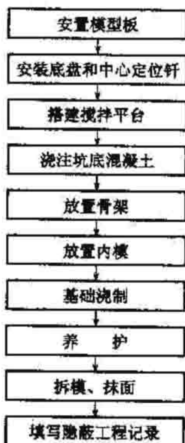
图 5.2.1—2 杯型 基础浇制施工 工序流程
