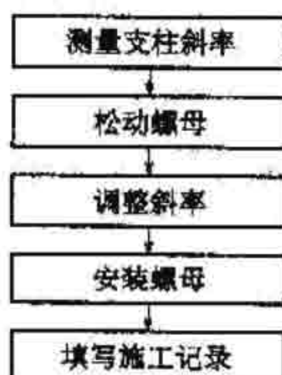
图 7.5.1 桥钢柱整正施工工序流程
