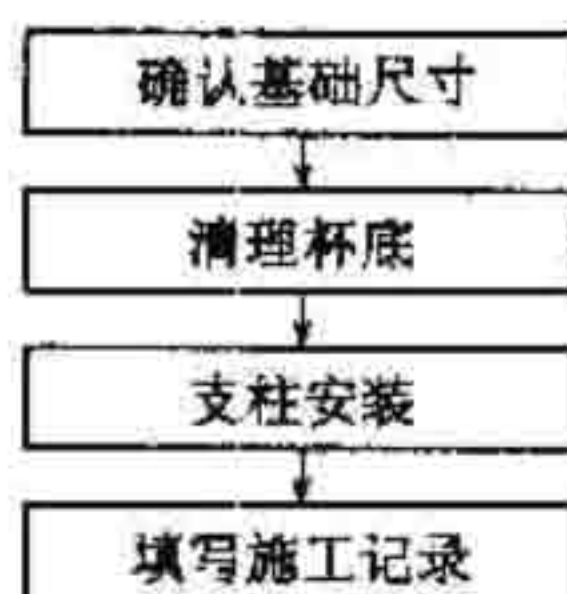
图 6.4.1 杯型基础支柱组立施工工序流程
