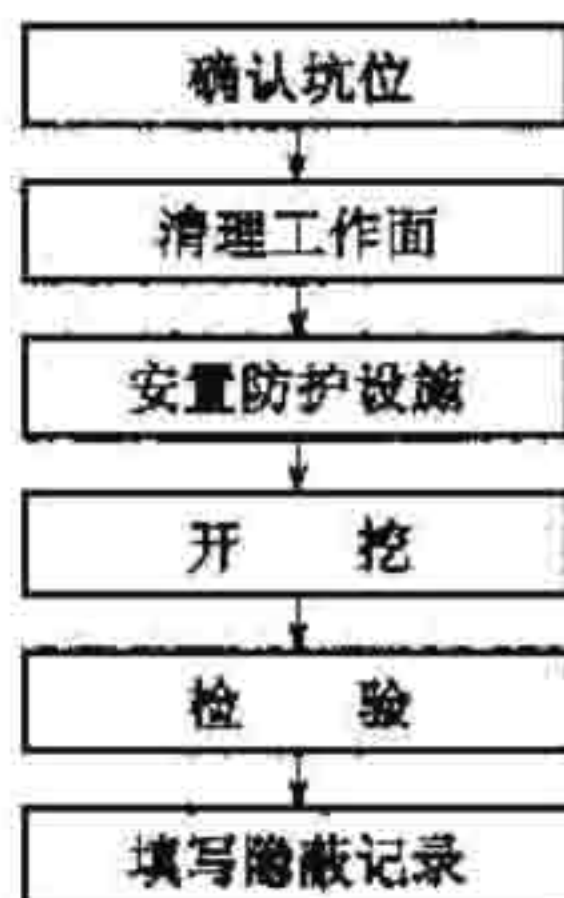
图 4.1.1 基坑施工工序流程
