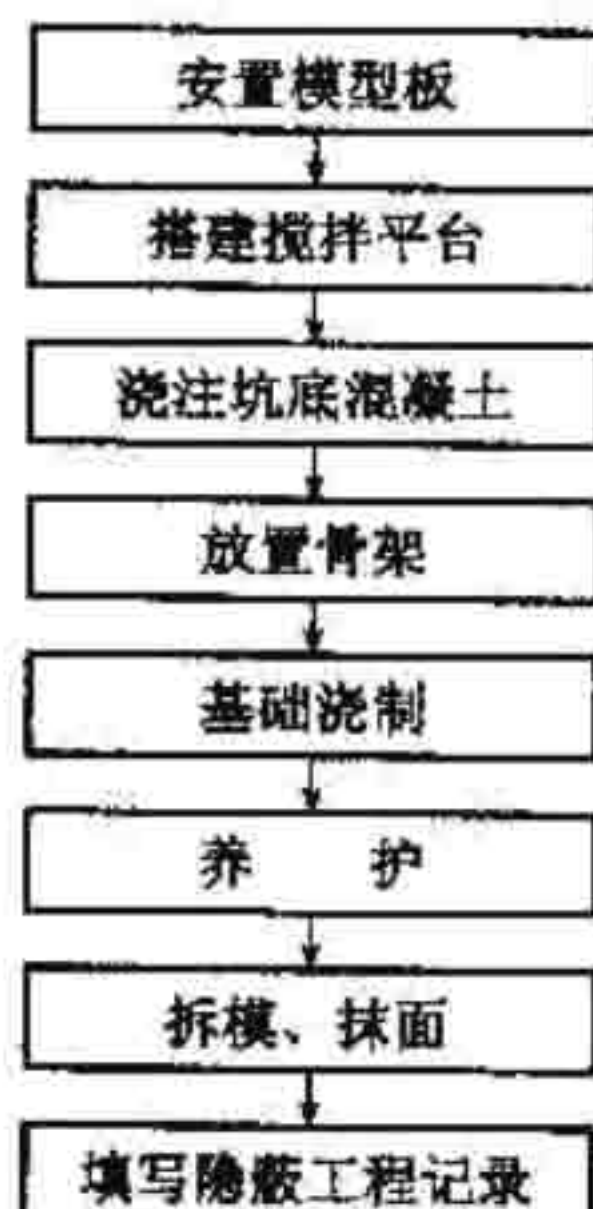
图 5.2.1—3 拉线 基础浇制施工 工序流程
