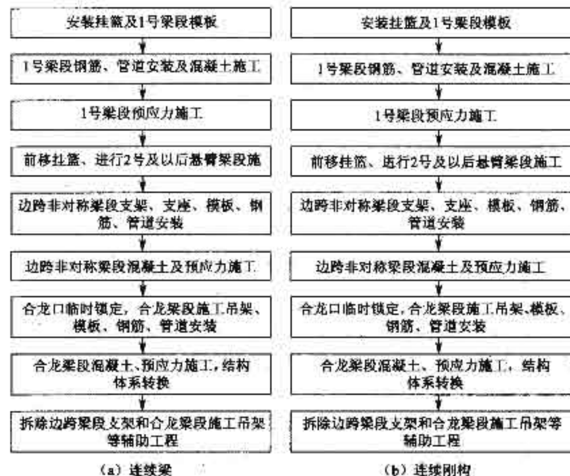
图 3.1.3 连续梁(刚构)悬臂浇筑施工流程图
