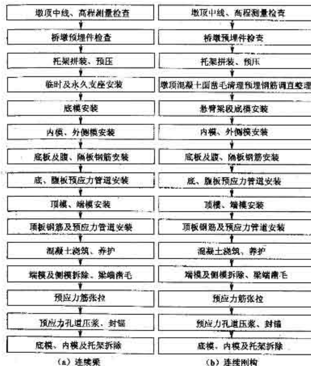
图4.1.2 0号梁段施工流程图
