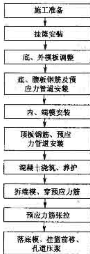
图 5.1.2 悬臂梁段施工流程图
