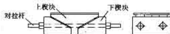
图 4.2.2 组合式钢楔块结构示意图
