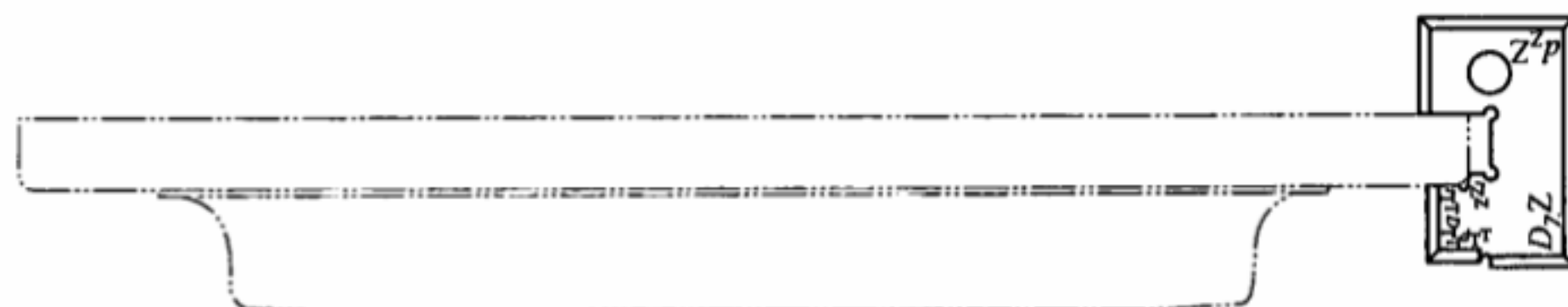
图 A.8 底板厚度检查
