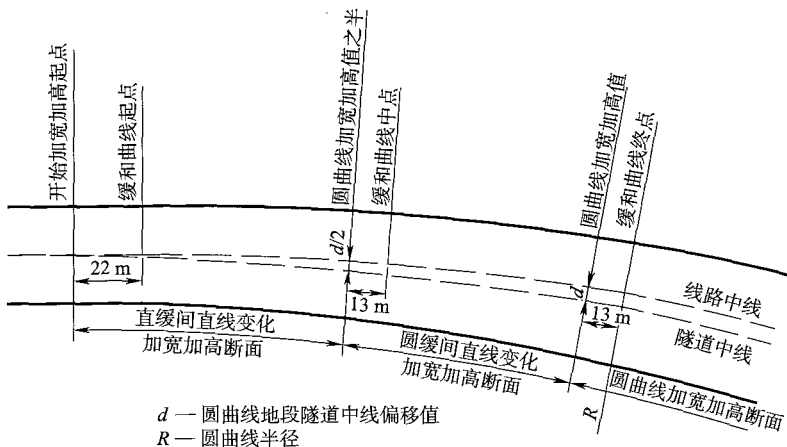
图 15.2.2 改建曲线地段隧道加宽加高示意图
