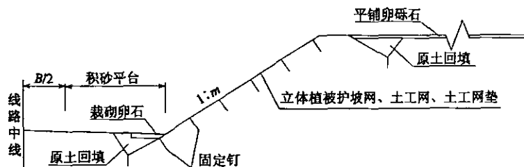
图 5.4.1—2 路堑坡面防护断面
