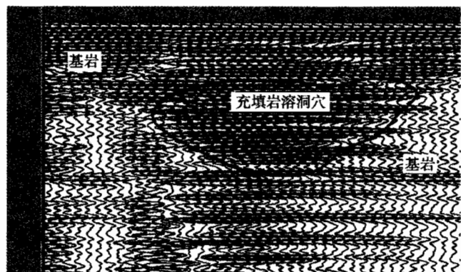
说明图 8.3.9—7 淤泥充填岩溶洞穴(二)
