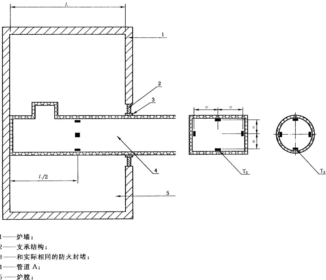
图5 厨房排烟管道/带可燃内衬层管道表面热电偶的位置
