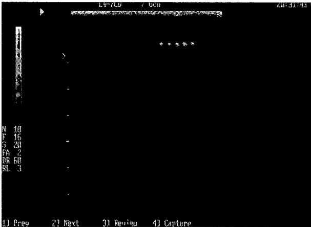
图 1 标准的灵敏度设定——标准试块的图像
