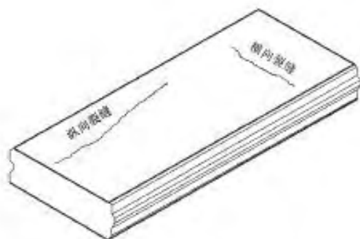
a) 纵向裂缝和横向裂缝示意
