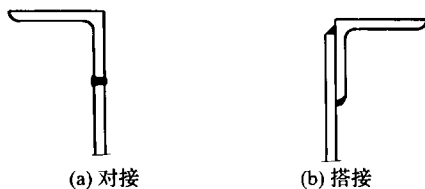
图 6.2.1 包边角钢与罐壁连接接头
