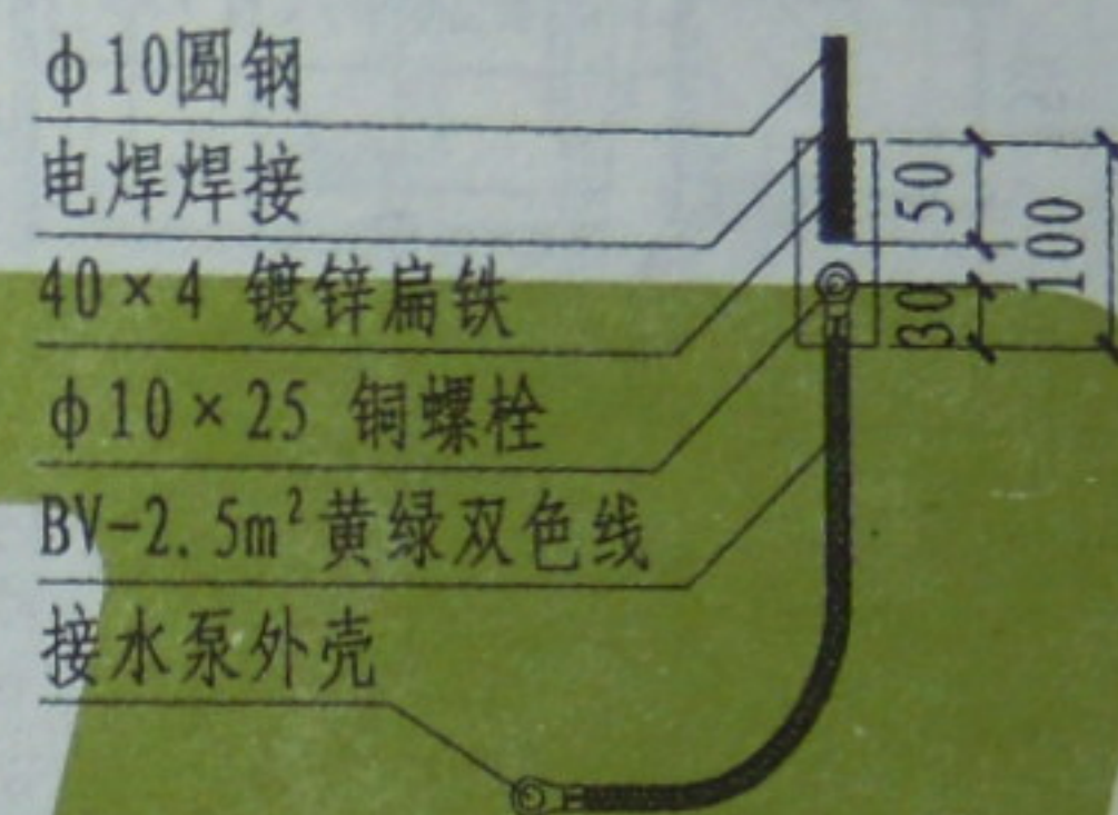
等电位接线端子联接大样图
