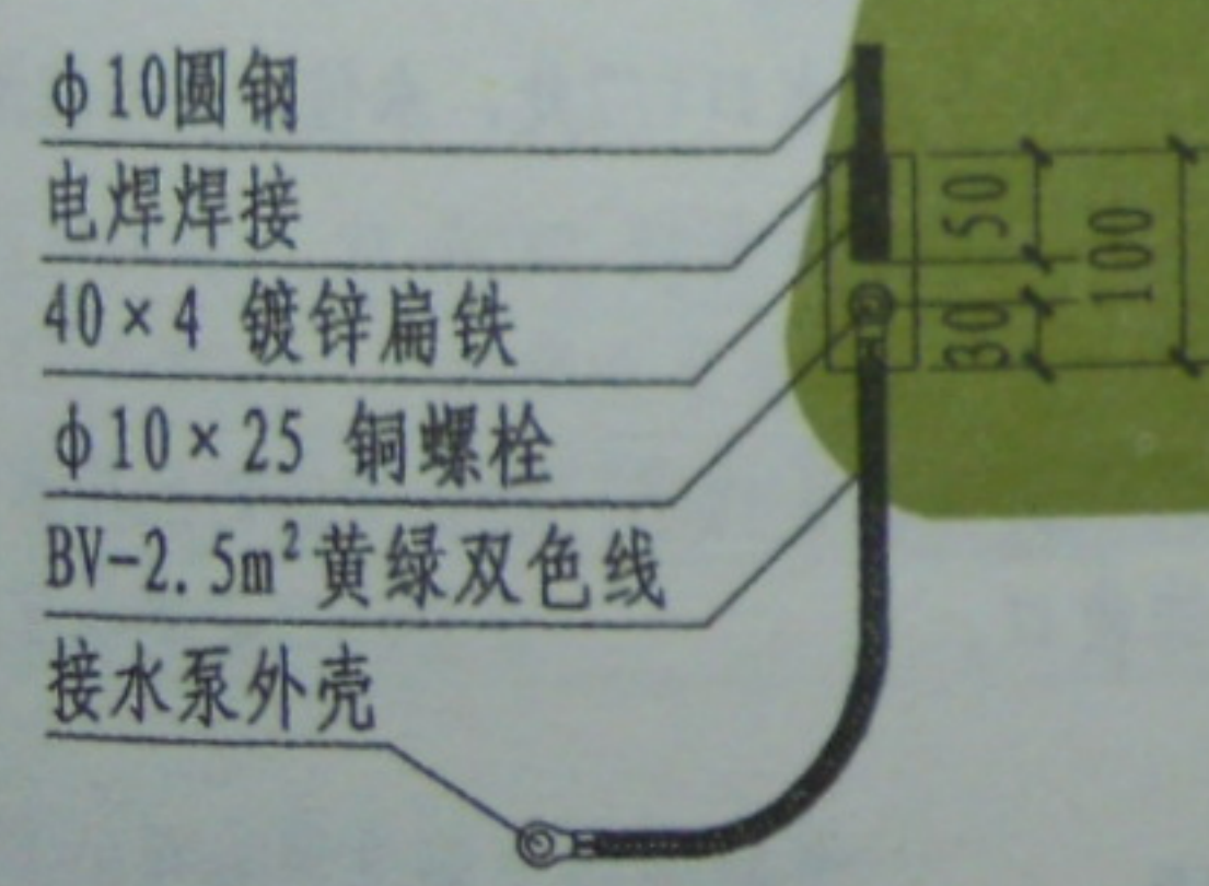
等电位接线端子联接大样图
