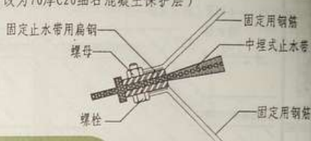
③ 止水带固定节点
