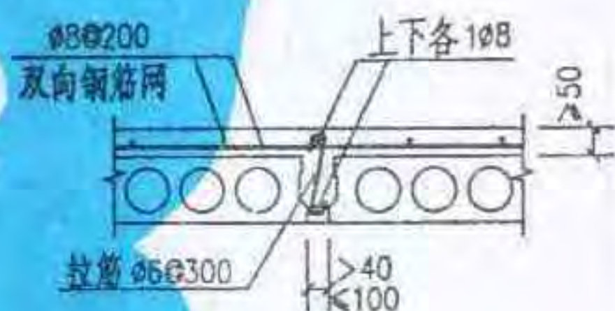
4 预制板板缝配筋构造
