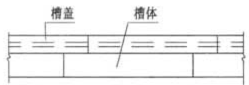
槽盖槽底错位搭接做法
