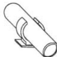
开口管卡安装示意
