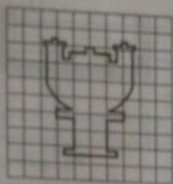
② 地下消火栓
