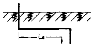
(b) 末端接垂直接地体的单根水平接地体
