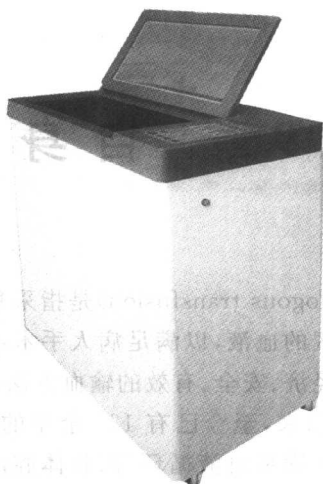
图 8-3 恒温循环解冻箱
